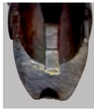
La découpe du bois au ras du ressort de l'embouchoir laisse entrevoir les vides rendant la solidité du fût très aléatoire.
